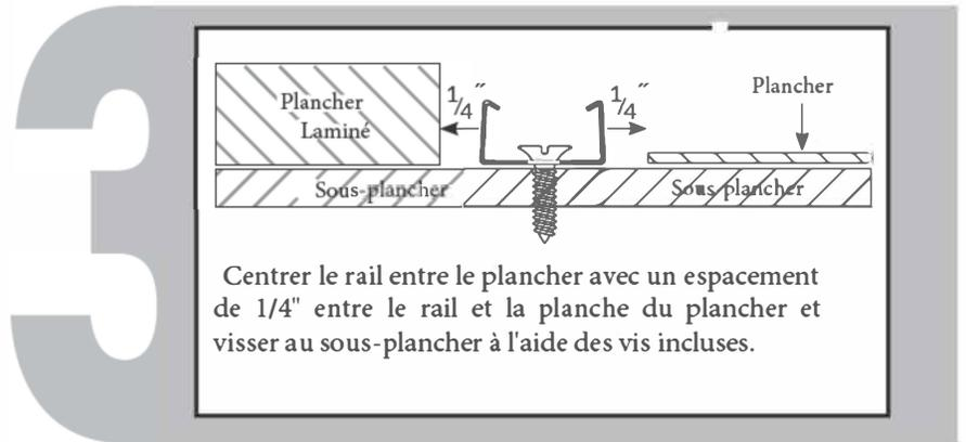
Centrer le rail entre le plancher avec un espacement de 1/4" entre le rail et la planche du plancher et visser au sous-plancher à l'aide des vis incluses.
