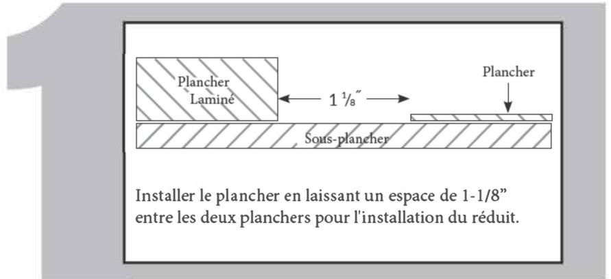
Installer le plancher en laissant un espace de 1-1/8" entre les deux planchers pour l'installation du réduit.
