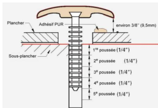
7. Lorsque l'application de l'adhésif est terminée, reprendre la procédure de l'étape 5 pour finir de pousser la moulure en place. Une fois celle-ci en place, utiliser un maillet en caoutchouc pour taper sur le dessus de chaque goujon. Utiliser les traits de crayon comme référence pour l'emplacement de chaque goujon.
